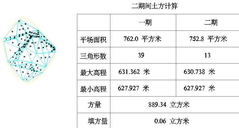
图 4-2 三角网法计算堆放矿石方量图
