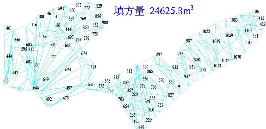
图 4-4 三角网法计算排土场堆方量图
