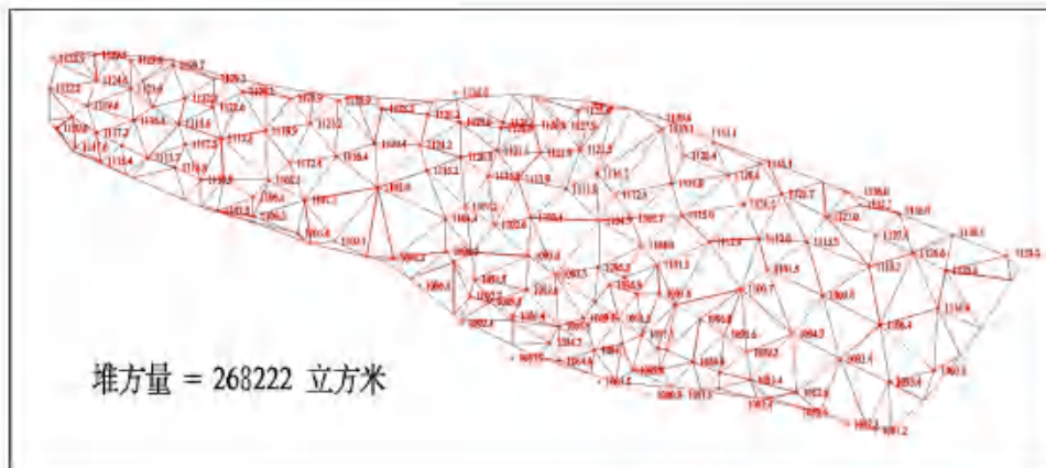
图 3-6 废石场 2 堆方量三角网法计算图
